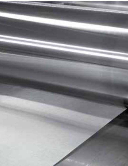
Oberflächenbearbeitung durch Kalandern
