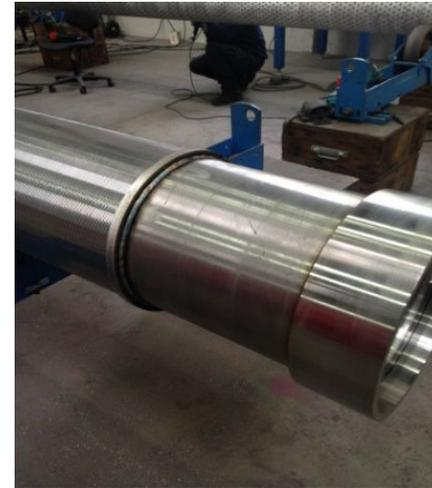
Direkt auf das Stützrohr gewickelte Filterrohre, d.h. ohne Spiel zwischen Stützrohr und Filterrohr, für besonders hohe Druck- und Zugfestigkeit
