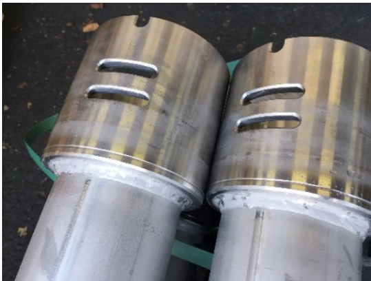
Steigleitung mit ZSM-Verbindungen
