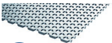
Rundlochung gestanzt z.B. Ø 1,5 mm, Teilung 2 mm in Edelstahl der Stärke 1 mm
