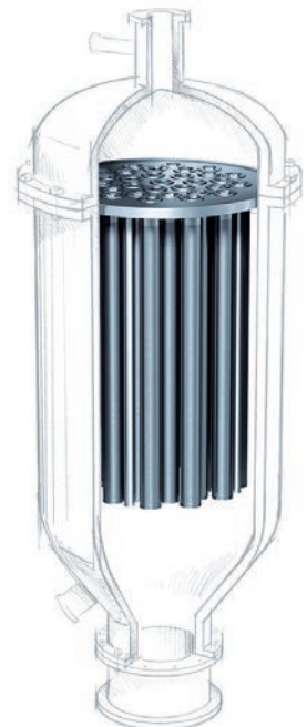
Filterkerzen aus Spaltsiebmaterial in der Getränkeindustrie
